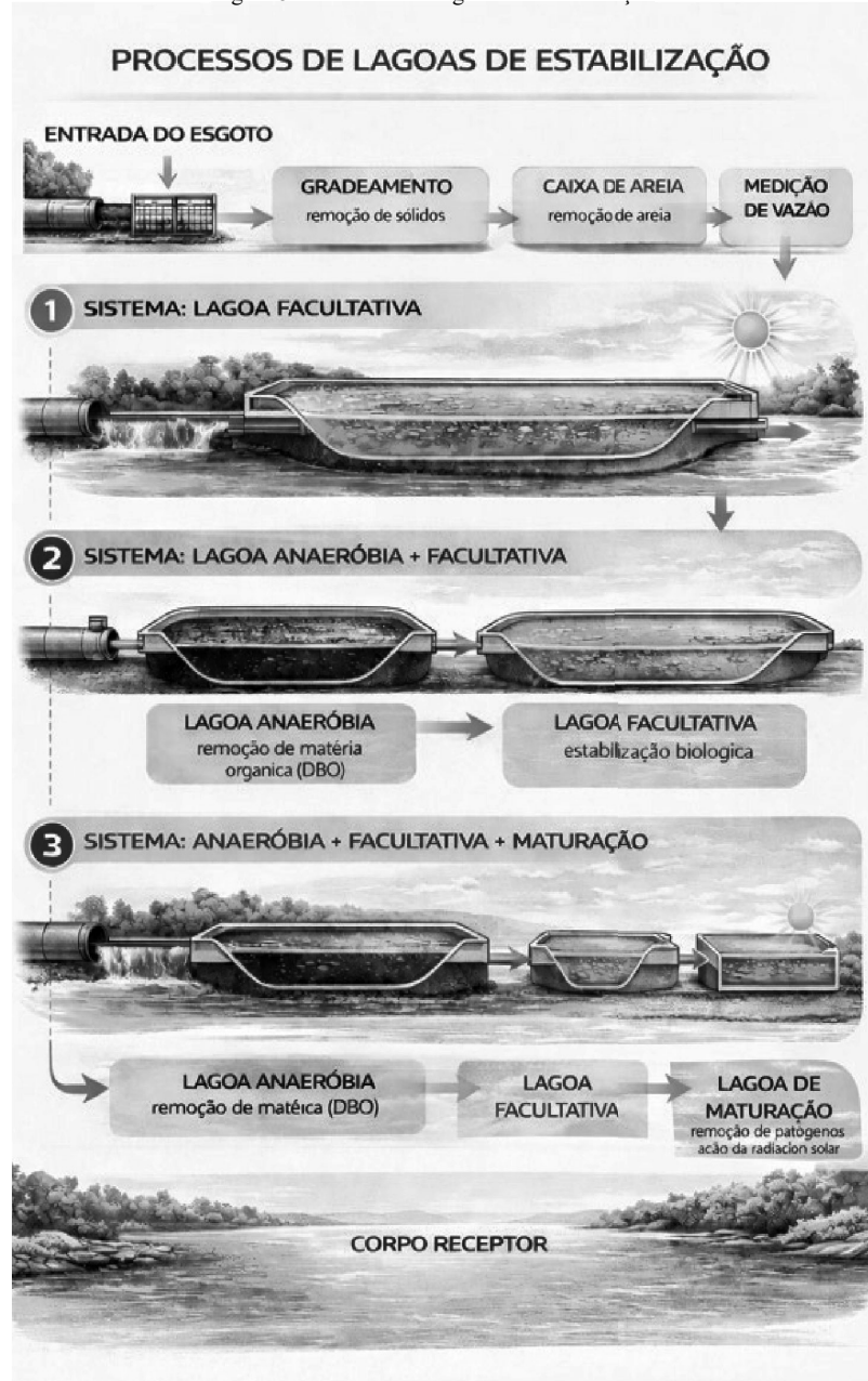
Figura 5 - Processo de Lagoas de Estabilização
